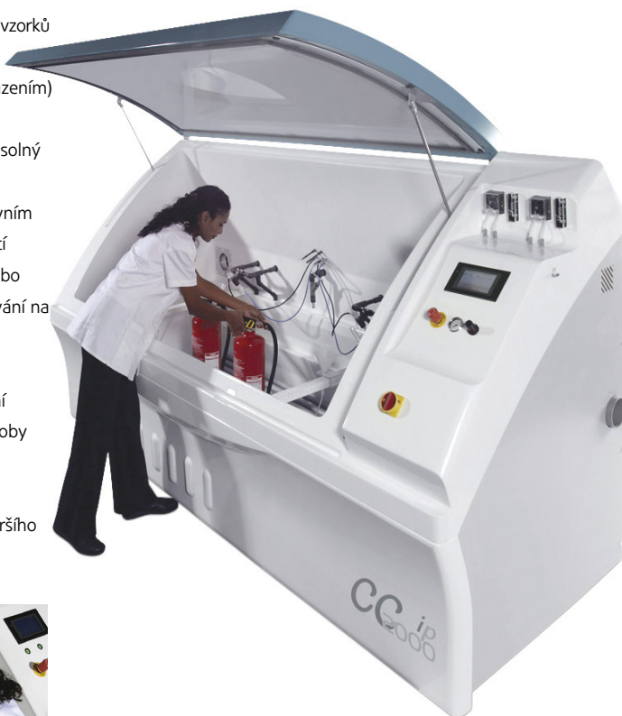
Korozní komora CCT o objemu 2000
